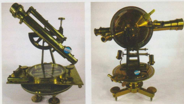
Bild 1, links: Tachymeter, Bussole, Forstbussole, Gerätenr. 7210, Hersteller: Neuhöfer & Sohn, Wien ca. 1900 – eine Spende von Gustav Thorban aus Crailsheim-Satteldorf. Die Firma Neuhöfer wurde 1857 gegründet und baute u. a. Universal-Bussoleninstrumente.
