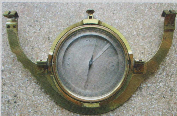
Hängebussole – auffällig ist eine Asymmetrie – die drei fingerbreiten, haltgebenden Einsparungen am linken Aufhängearm
