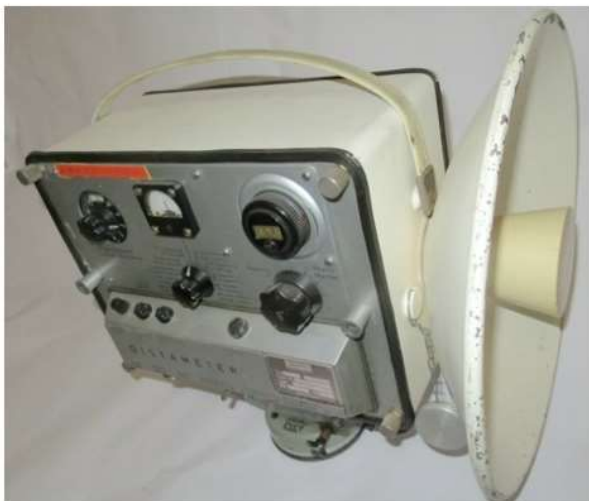
Bild 1: Distameter, mit Grundig-Emblem, einer der früheren deutschen elektronischen Distanzmesser, Grundig-Elektronik GmbH, 1966 - eine Schenkung des Landschaftsverbandes Westfalen-Lippe
