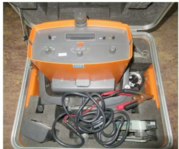
Bild 2: Weiterentwicklung der elektronischen Distanzmessung, hier in Form einer Total-Station, ab ca. 1976, von Hewlett Packard, 3810 A, Nr. 1648A00972 - freundliche Gabe der Wohlleben GmbH, Oberursel
