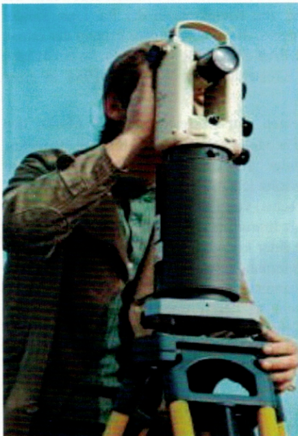
Abb.11: Meridiankreisel MK 10 (BGT) mit Askania Theodolit (links) und Querschnitt zum Funktionsprinzip (rechts), aus Originalprospekt BGT
