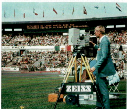
Abb. 12: Das Erste elektronisches Tachymeter RegElta 14 von ZEISS (1968)
