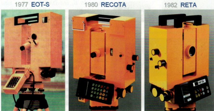
Abb. 9: Erste elektronische Tachymeter aus Jena (1977-1982)
