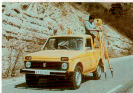
Abb. 6: Motorisiertes Präzisionsnivellament mit Ni 002 aus Jena (1975)
