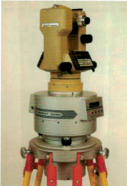
Abb. 9: Gyromat 2000 mit elektr. Theodolit Wild T 1600, aus Originalprospekt DMT
