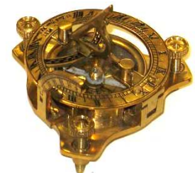
Sonnenuhr: Fa. F.L. West, London: ca. 1860 Mit einer Sonnenuhr läßt sich die lokale Sonnenzeit (– Orszzeit ) bestimmen. Hierzu wird der Stundenkreis auf die ungefähre geographische Breite des Standortes gekippt. Damit steht der Gnomon (– Zeiger ) parallel zur Erdachse und eine Ablesung wird ermöglicht.
