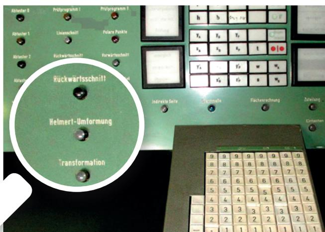
Bild 2: Festverdrahtete Z11-Vermessungsprogramme, Programmauswahl per Knopfdruck
