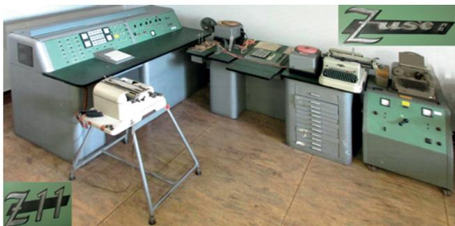
Bild 1: Gesamtansicht Z11 (kein Zusatzschrank für Speicher)
