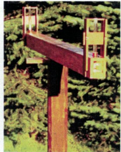
Bild 8: Nivellieraufsatz (Kanalwaage)
