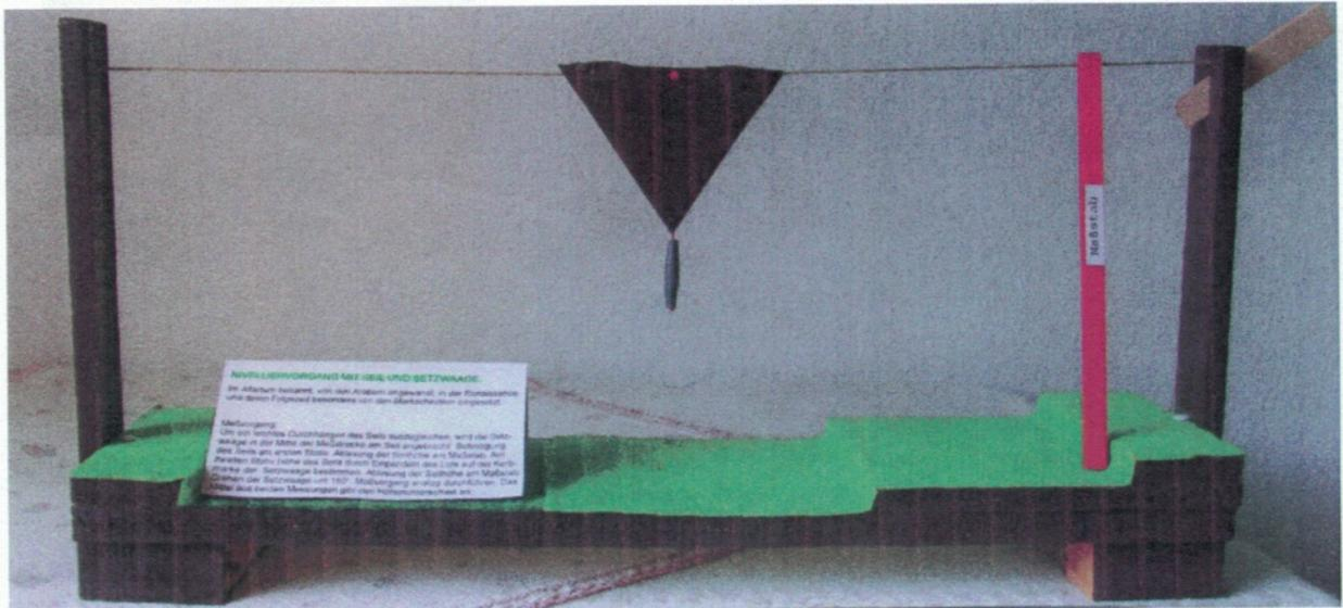
Bild 9: Nivelliervorgang mit am Seil hängender Setzwaage
