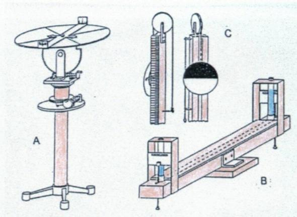
Bild 7: Herons Dioptra (A) mit Nivellieraufsatz B und Nivellierlatte C
