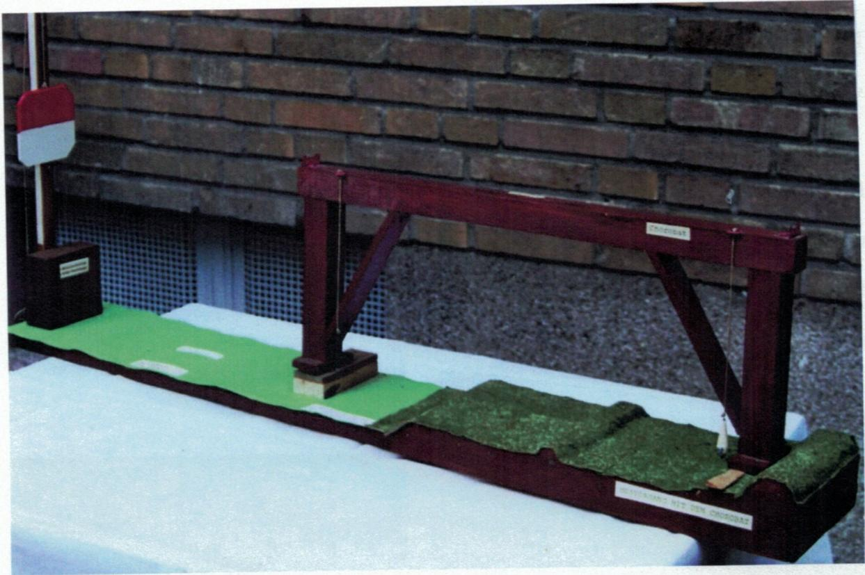
Bild 6: Chorobat mit Nivellierlatte beim Messvorgang
