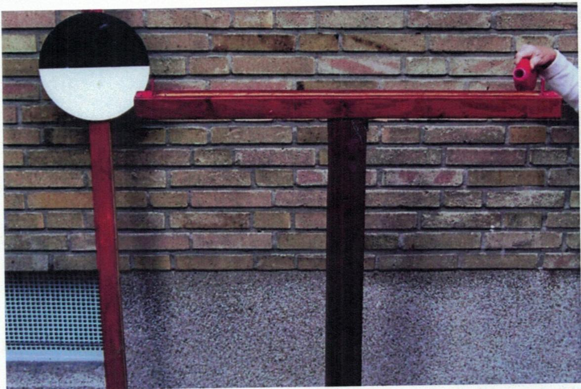
Bild 2: Offene Wasserwaage
