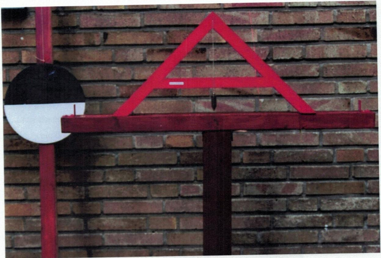
Bild 4: Setzwaagenivellier (stehende Waage)
