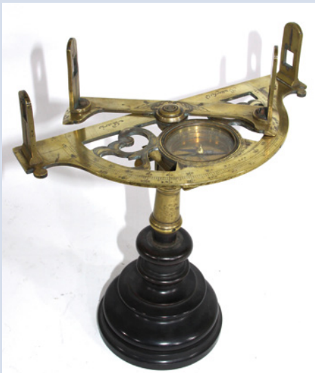
Bild 1: Graphometer „Butterfield a Paris“
